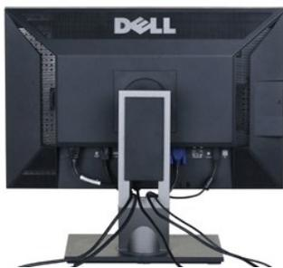
将所有必需的电缆连接到显示器和电脑之后（参见“[连接显示器](#)”以了解电缆的连接），用电缆夹圈将所有电缆束扎整齐（如上图所示）。
